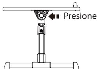
Presione simultáneamente los botones de ambos lados de la mesa (los indicados en la imagen) para ajustar la inclinación del tablero
