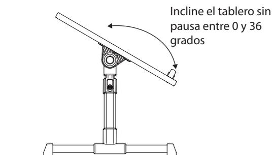
Ajuste la inclinación hasta la posición deseada y suelte los botones
