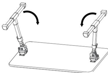
Pliegue las patas de la mesa en la dirección de las flechas para plegar la mesita
